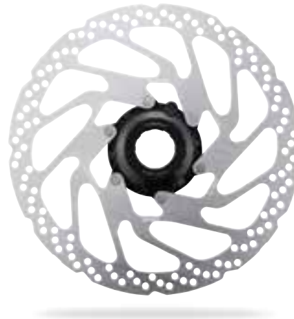
RT-EM300 CENTER LOCK Bremsscheibe mit Magnet für E-Bike Geschwindigkeitssensor (203 mm)
